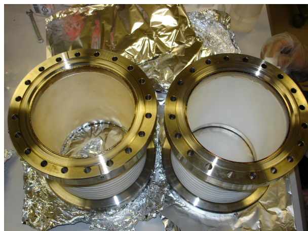
図5. 電子銃セラミクス碍子の写真。左は放電の頻発で取り外した直後のもので、セラミクス内面が黄色く変色している。右は代わりに取り付けた予備の碍子。
