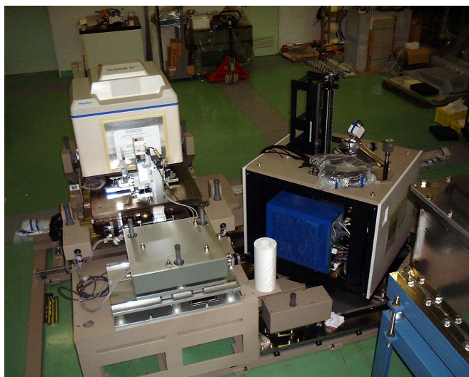
写真4 実験室に建設中の移動式タンパク質高次自動構造解析装置(左)と微小部X線自動回折装置
