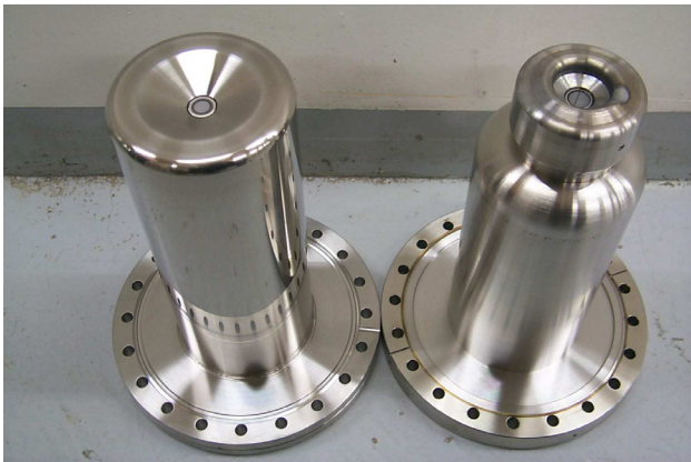
図3：電子銃ウェーネルト電極形状。左が新電子銃、右が旧電子銃。
