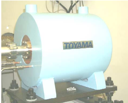
図2：PXR用ビームダンプの写真
