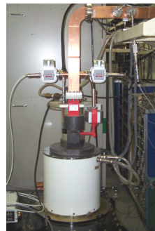
図 1: クライストロン PV-3030A1(三菱電機製)。RF 窓下流で真空排気強化を行っている。
