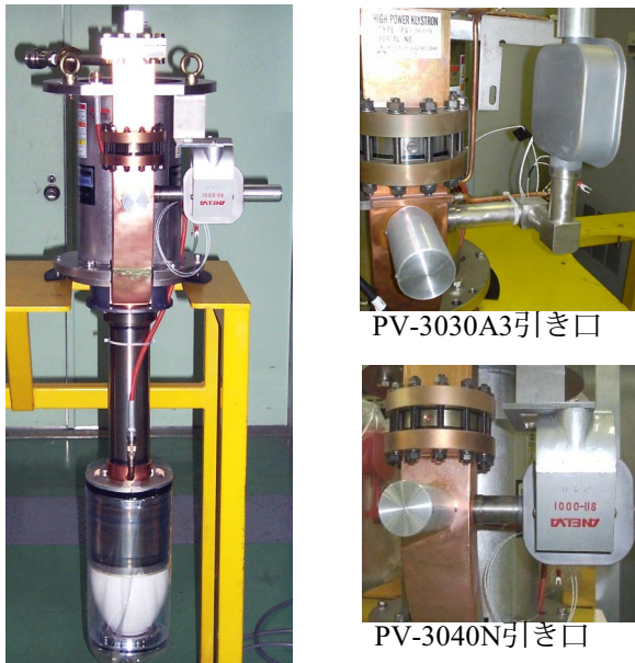
図1：PV-3040Nクライストロン外観写真。PV-3030A3をベースに改良している。真空引き口の内径を大きく、長さを短くして真空排気能力を向上させ、PV-3030A1（約1.2l/s）に比べ実効排気量はおよそ3.3l/sに増加している（気温20℃の場合に換算）。
