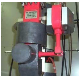
図2：クライストロン PV-3030A1 のイオンポンプ引き口の様子。内径 15mm の円筒ダクトを直角に2回曲げて ANELVA 製 8ℓ/s イオンポンプへ繋げている。RF 窓上流部の実行排気量はおよそ 1.2ℓ/s。
