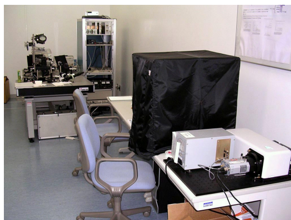
図6. 光電子分光レーザー照射実験室の光学用部品保管棚（左）とラマン分光測定装置（右手前）。
