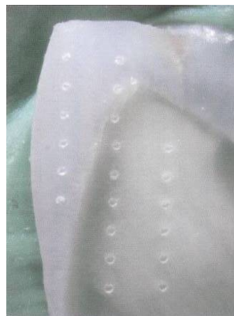
Fig.5. ヒトの歯に対する LEBRA-FEL 照射実験 歯の研磨標本に LEBRA-FEL を照射して形成された pit はきれいな円錐状をしており、焦げなどは観察されなかった。
